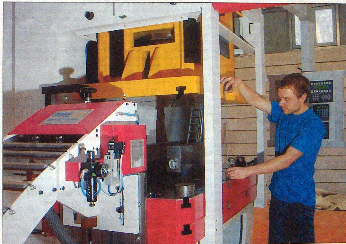
Mitarbeiter Sven Wiedrich beim Einrichten der neuen 315-Tonnen-Exenterpresse in der neu errichteten Halle der Oederaner Stanz- und Umformtechnik GmbH.
